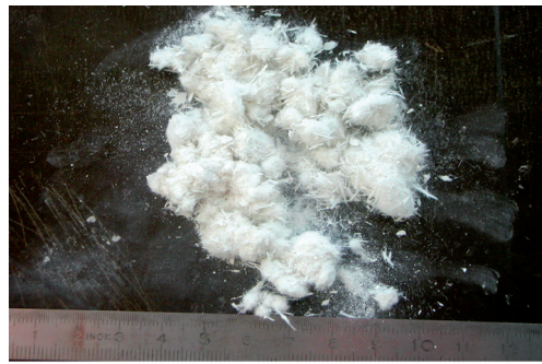
Fig. 3. Procédé de conditionnement et observations du broyat incluant une étape de déchiquetage du déchet SMC.
