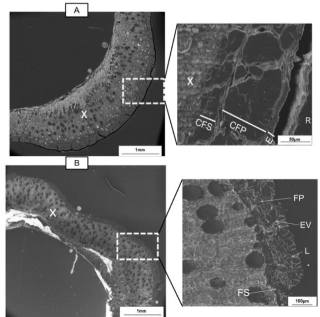
**Figure 5.** Images MEBE de coupes transversales de tiges de chanvre A) non rouies (NR) et B) rouies (R). E: épiderme; CFB: couche des faisceaux de fibres primaires; CFS: couche des faisceaux de fibres secondaires; L: lumen; FB: fibres primaires (élémentaires); FS: fibres secondaires (élémentaires); EV: espaces vides; X: xylème
